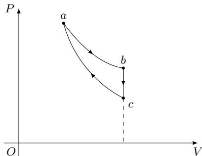
Siklning FIKi 40 % bo'lib, ideal gazning maksimal va minimal temperaturalar farqi 400 K ga teng bo'lsa, **gazning izotermik jarayonda bajargan ishini (kJ) aniqlang.**
